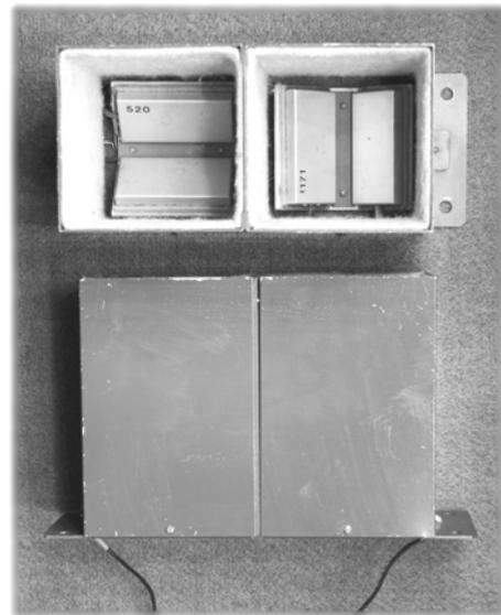
Fig. 8. The actual image of unidirectional acoustic antenna
